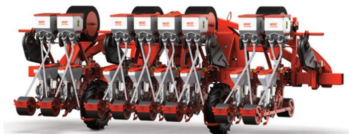
che ne permette il controllo tramite motori elettrici per il distributore del seme e il dosatore del microgranulatore da 16 litri. Il nuovo design del distributore ottimizza il contatto con i semi, grazie a un profilo interno lucidato che garantisce un flusso regolare per qualsiasi tipo di seme, dalla rucola alla barbabietola.
